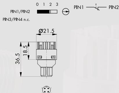
**Bloc de contact à impulsion avec connecteur M12 à 4 pôles**
