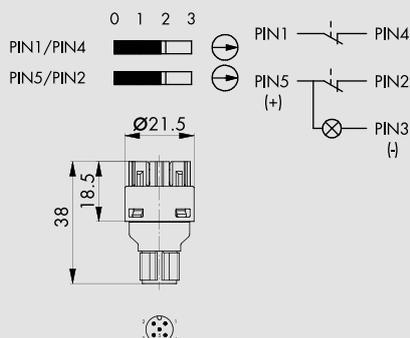
**Bloc de contact lumineux à impulsion avec connecteur M12 à 5 pôles**
