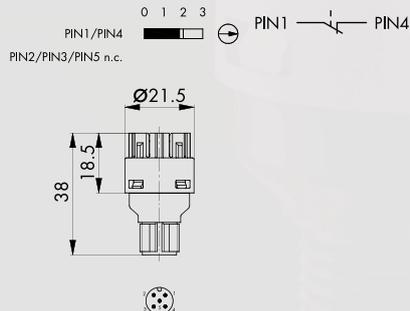
**Bloc de contact à impulsion avec connecteur M12 à 5 pôles**
