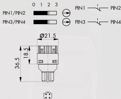
**Bloc de contact à impulsion avec connecteur M12 à 4 pôles**
