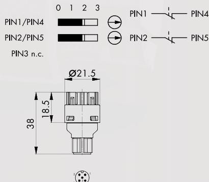
**Bloc de contact à impulsion avec connecteur M12 à 5 pôles**
